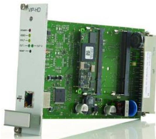
Рисунок 22 –Плата детектора видеосигналов VIP-HD
