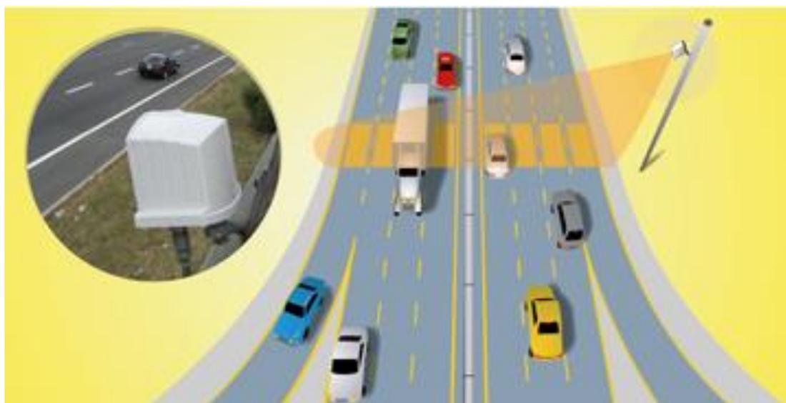
Рисунок 2 – Радиолокационный детектор транспорта (доплеровский радар с малым временем дискретизации и нулевой «слепой зоной»)
