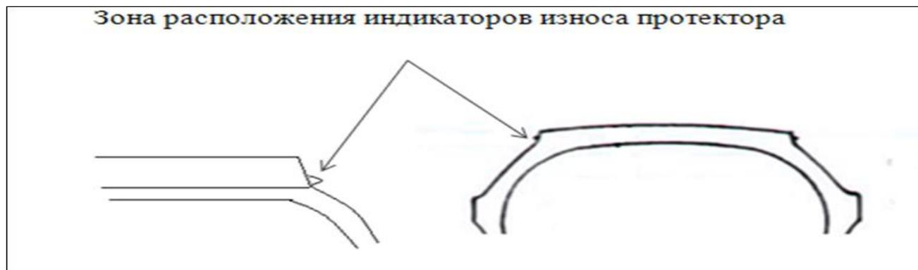
Рисунок 1. Индикаторы износа протектора
